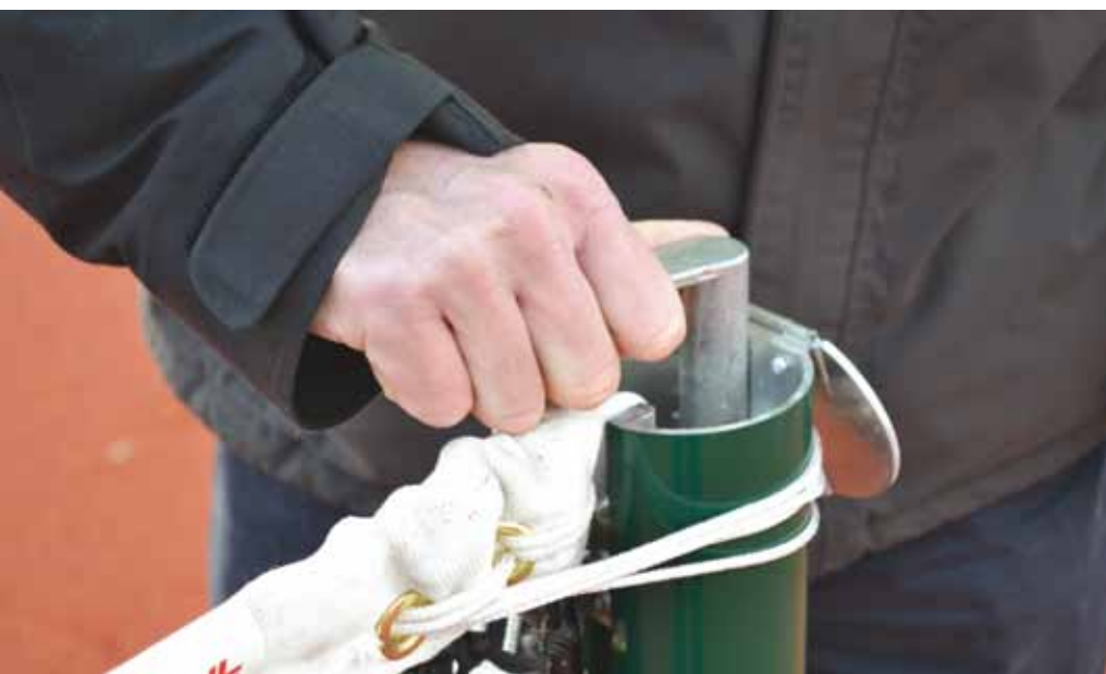
De netpalen met inwendig spanmechanisme staan in potten.
