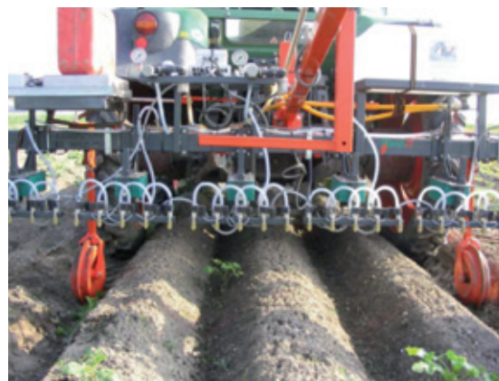
Figuur 2. Precisiebespuiting maakt een sterke reductie van gewasbeschermingsmiddelen mogelijk.
