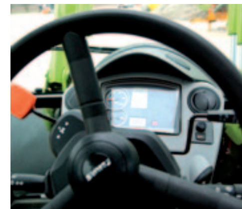
De Claas Arion 430 CIS heeft een modern dashboard: digitaal en deels analog.
