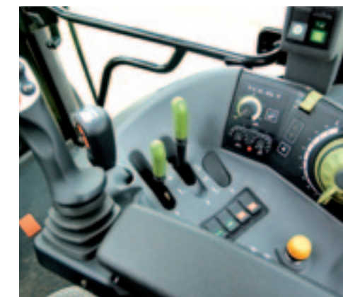
De bediening is overzichtelijk, al is de 'start-beveiliging' van de hef lastig te doorgronden. Van de vier DW-ventielen zitten er twee op de joystick.
