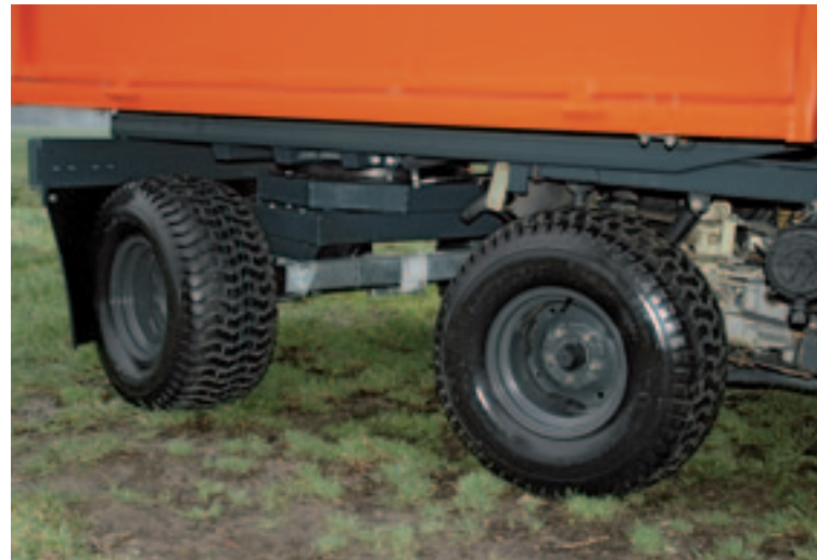
De derde as van de SCK 6x4 is bevestigd aan een draaischamel en wat betreft de stuuruitslag gekoppeld aan de uitslag van de voorwielen. De SCK draait daardoor scherp en komt nagenoeg zonder wringen de bocht om.
