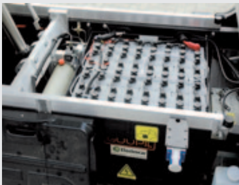
De accu's zijn voorzien van een centraal vloeistofvulsysteem.
