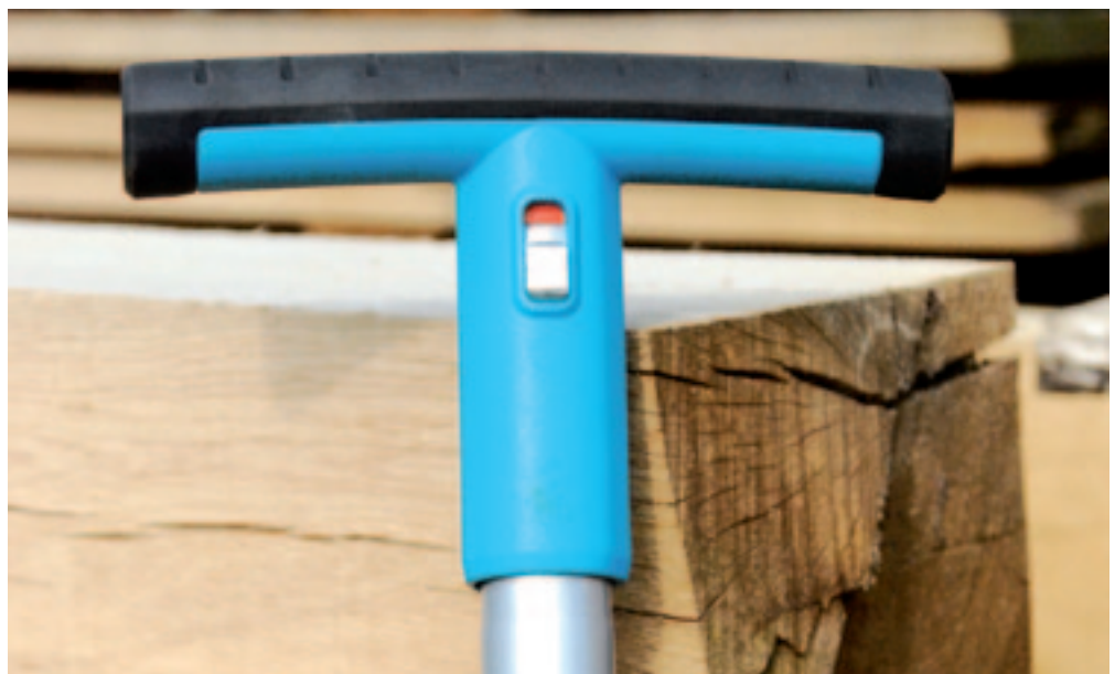
De veerbelaste 'slag' van 1 cm vangt harde klappen effectief op. Dat spaart het polsgewicht.
