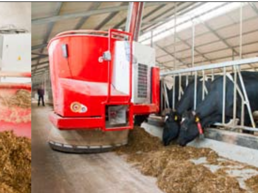
Een sensor meet de gewenste kilo's voer
