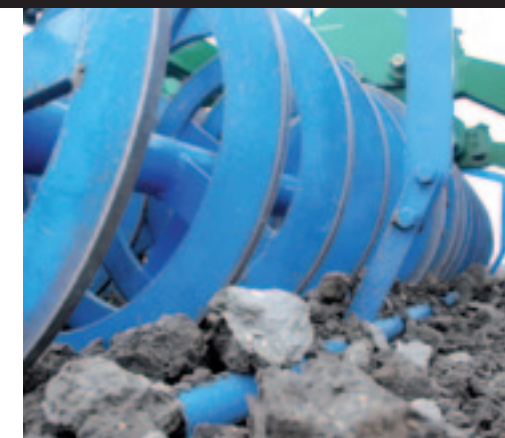
▲ Een ronde egalisatiebuis houdt de grond langer in de spiraalrollen, wat de verkrumeling en egalisatie ten goede komt.
