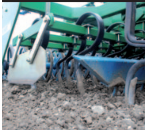
▲ De zijkanalen van de egalisatieplaat lopen schuin omhoog af, zodat de losse grond binnen de machine blijft.
