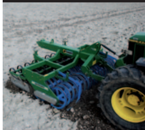
▲ Het frontwerktuig hangt aan een zware kokerbalk en is om te bouwen naar een achteruitvoering.
