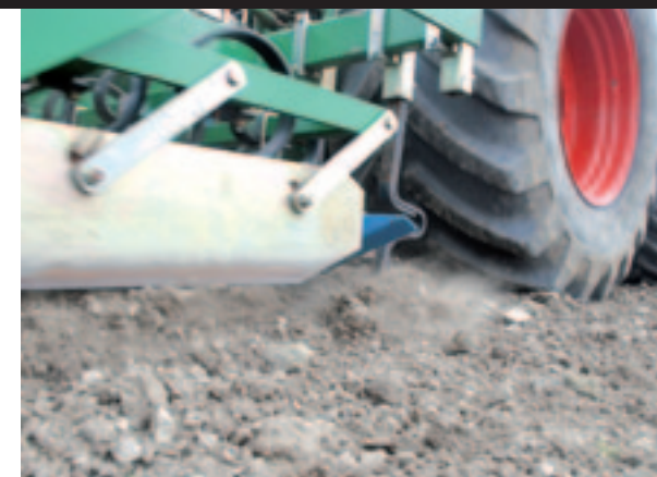
▲ Een parallel scharnierende beschermplaat voorkomt dat de grond buiten het bereik van de machine spat.
