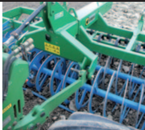
▲ De dubbele spiraalrollen hebben vooral de functie om de losgewerkte grond te verdelen.
