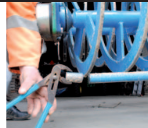
▲ Omdat de egalisatiebuis de grond net iets te ver buiten de machine bracht, is er aan beide zijden 5 cm afgeslepen.
