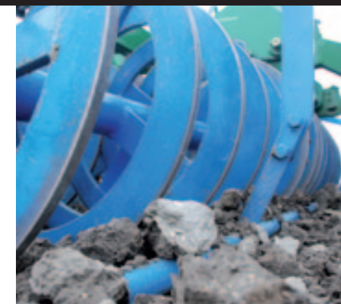
▲ Een ronde egalisatiebuis houdt de grond langer in de spiraalrollen, wat de verkrumeling en egalisatie ten goede komt.
