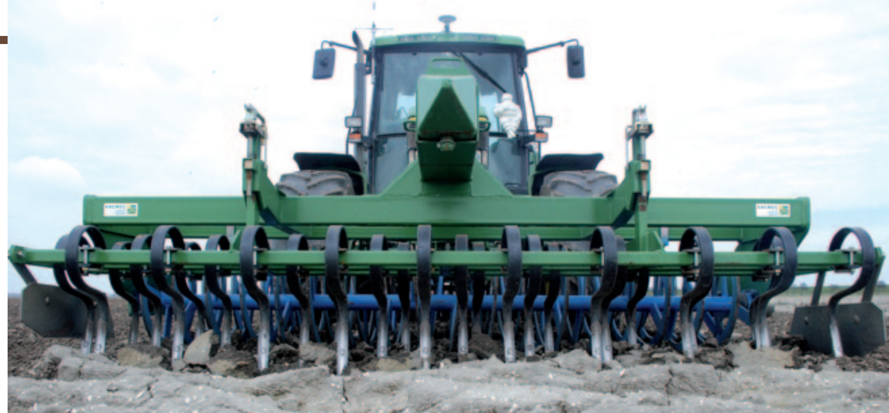
▲ Omdat een looprol op het frontwerktuig ontbreekt, is een goede afstelling van de topstang vereist. Vooral op lichte grond hebben de spiraalrollen de neiging om dieper te gaan lopen, waardoor de veertanden meer stekend komen te staan en meer grond lostrekken.
