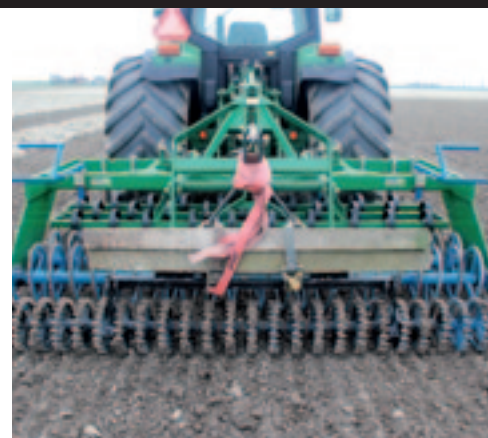
▲ De hef van de Synchrosem is enkelwerkend. Twee dampalen zorgen hier voor extra gewicht op de crosskillrollen.
