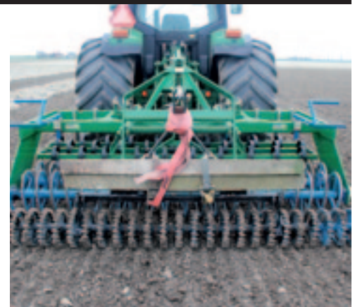
▲ De hef van de Synchrosem is enkelwerkend. Twee dampalen zorgen hier voor extra gewicht op de crosskillrollen.
