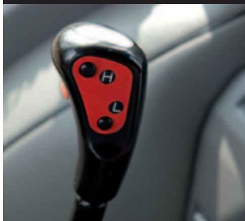
▲ De versnellingsbak van de Zetor Forterra 140 HSX heeft vijf versnellingen en drie automatisch schakelende powershifttrappen.
