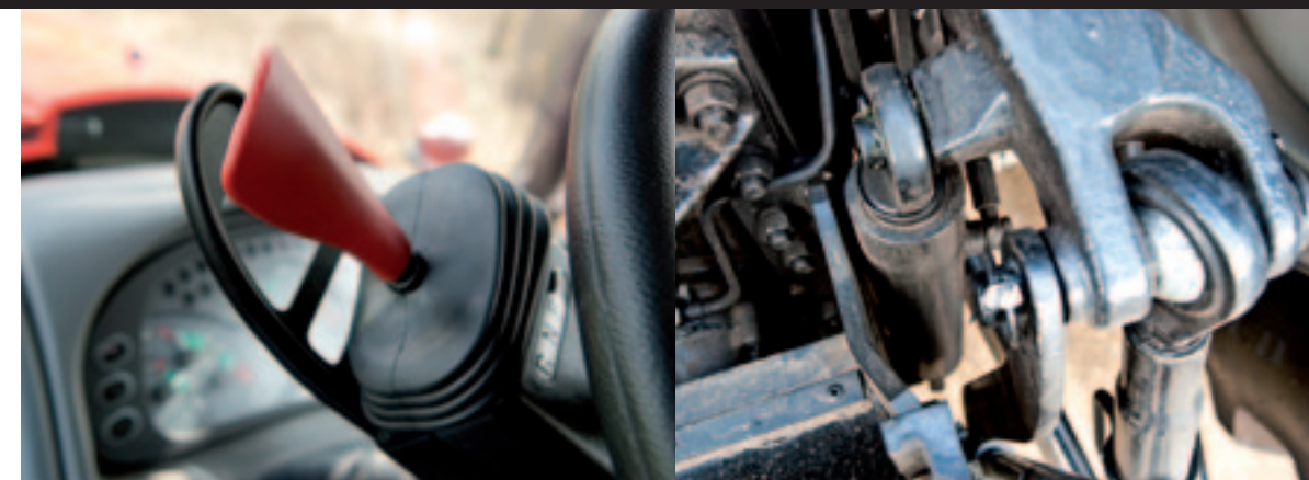
▲ Een van de opvallende verbeteringen aan de Forterra-serie is de elektrohydraulische omkeer. De hendel bevindt zich links onder het stuur.
