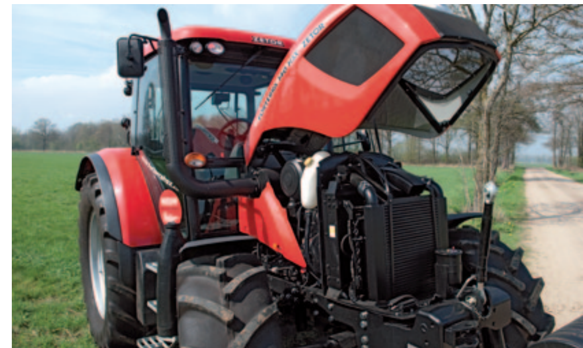
▲ Onder de motorkap van de Zetor Forterra 140 HSX ligt een mechanisch ingespoten Zetor viercilindermotor met vier kleppen per cilinder. Door middel van EGR voldoet de motor aan de Stage 3b-emissie-eisen.
