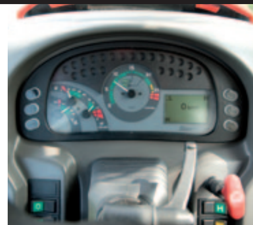
▲ Het dashboard is vernieuwd. Een digitaal display geeft de rijsnelheid, het motor- en aftakstoerental en de powershifttrap weer.
