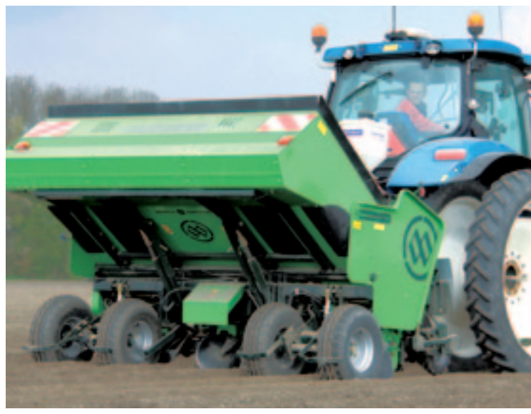
▲ De gedragen CP42T is leverbaar met zowel een centraal hydraulische als mechanische aandrijving. De kibbunker heeft een inhoud van 2.050 kg.
