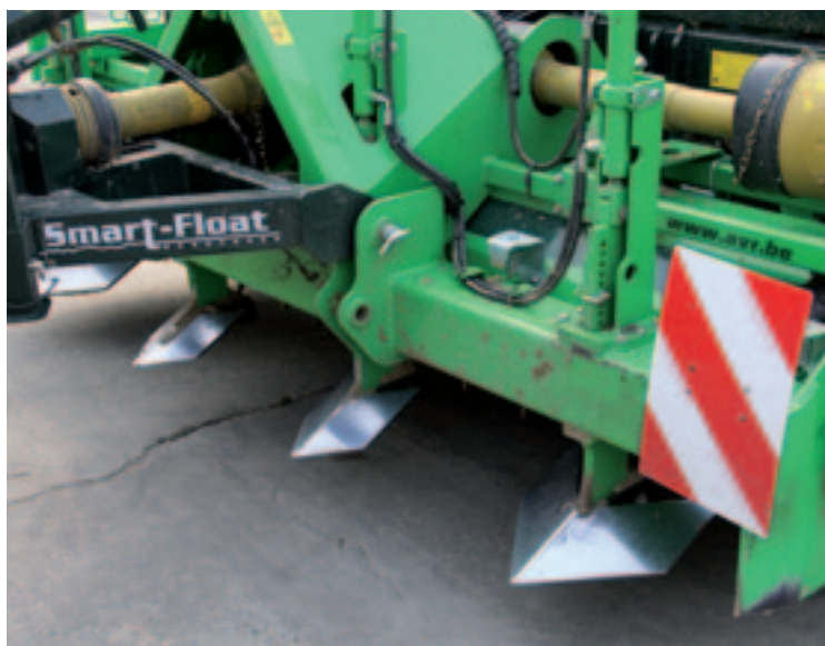
▲ Brede beitels zijn een optie, vooral bedoeld voor de lichtere grond. De tanden zijn hydraulisch in diepte te verstellen.
