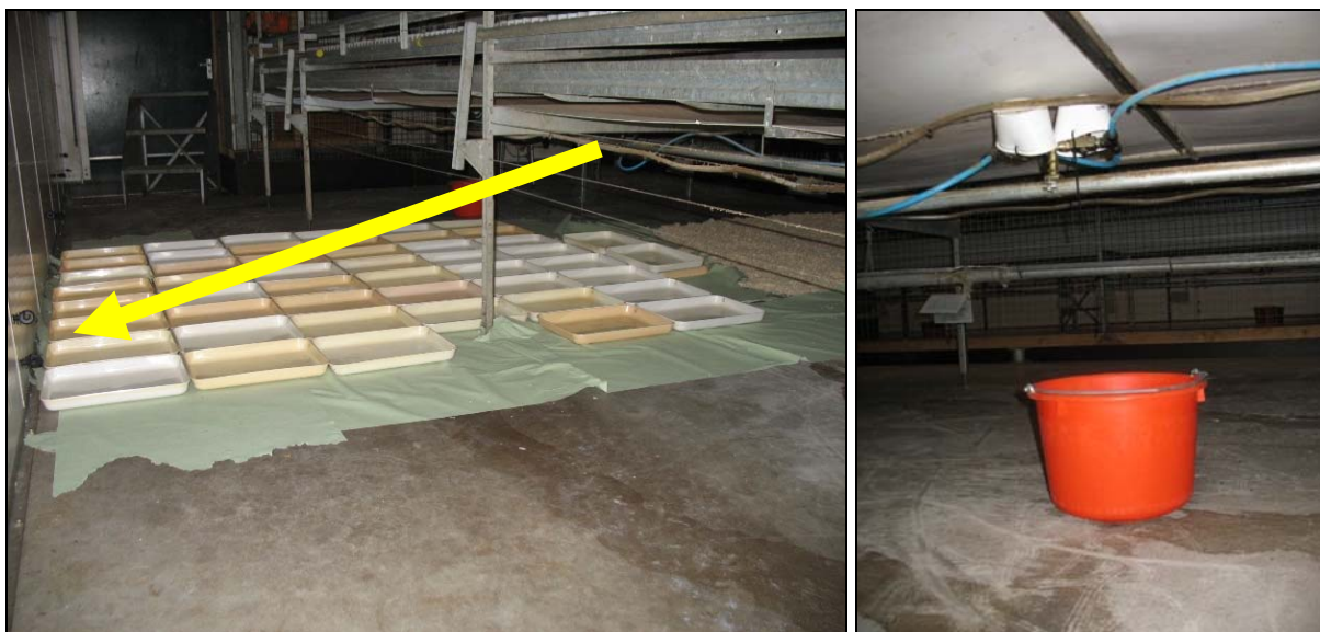
Figuur 2 Links: opstelling van de bakken voor één van de vier geteste nozzles (nozzle 2). Rechts: afgedekte nozzle waarmee geen bakkenproef werd verricht
