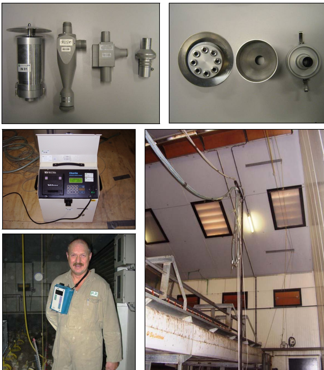
Figuur 8 Monsterapparatuur voor PM10 en PM2,5. Linksboven (van links naar rechts): de inlaat, PM10 en PM2,5 cyclonen en filterhouder. Rechtsboven: de constructie van de inlaat van de cycloon. Linksmidden: een 'constant flow' monsternamerpomp. Linksonder: meten van de persoonlijke stofbelasting met de DustTrak model 8520 gedragen aan het lichaam. Rechtsonder: positie van monsternamers in de stal, ca. 1,5 m onder de nok (meetgalg met ophangpunten voor meetkoppen)
