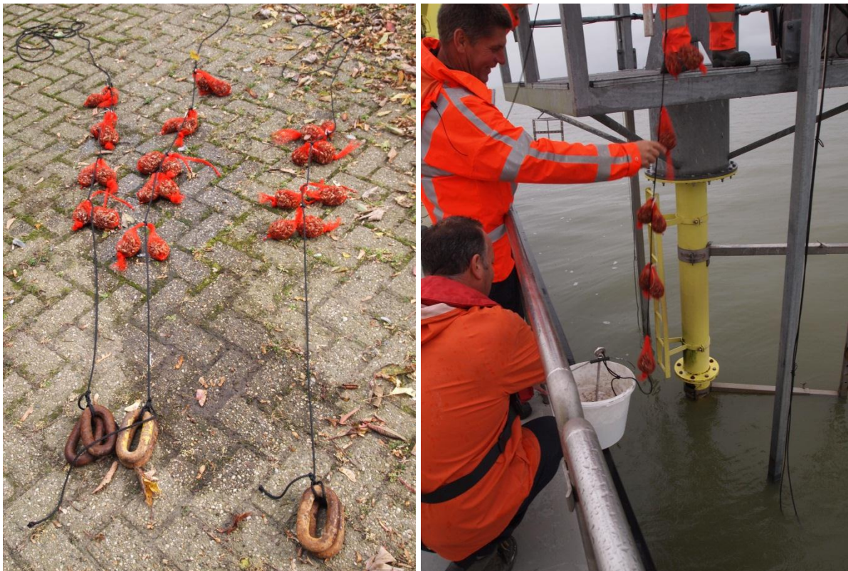
Figuur 2. Bevestiging van de mosselen aan het koord (links), uithangen van een koord aan een meetpaal in het Markermeer met een cementanker om het koord strak te houden (rechts).
