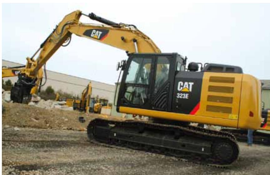
De 323E heeft nog een extra werkstand waarbij het motortoerental constant blijft, ongeacht de vraag naar hydraulisch vermogen. Deze regeling verlaagt ook het onbelaste motortoerental en dat draagt bij aan een lager verbruik.
