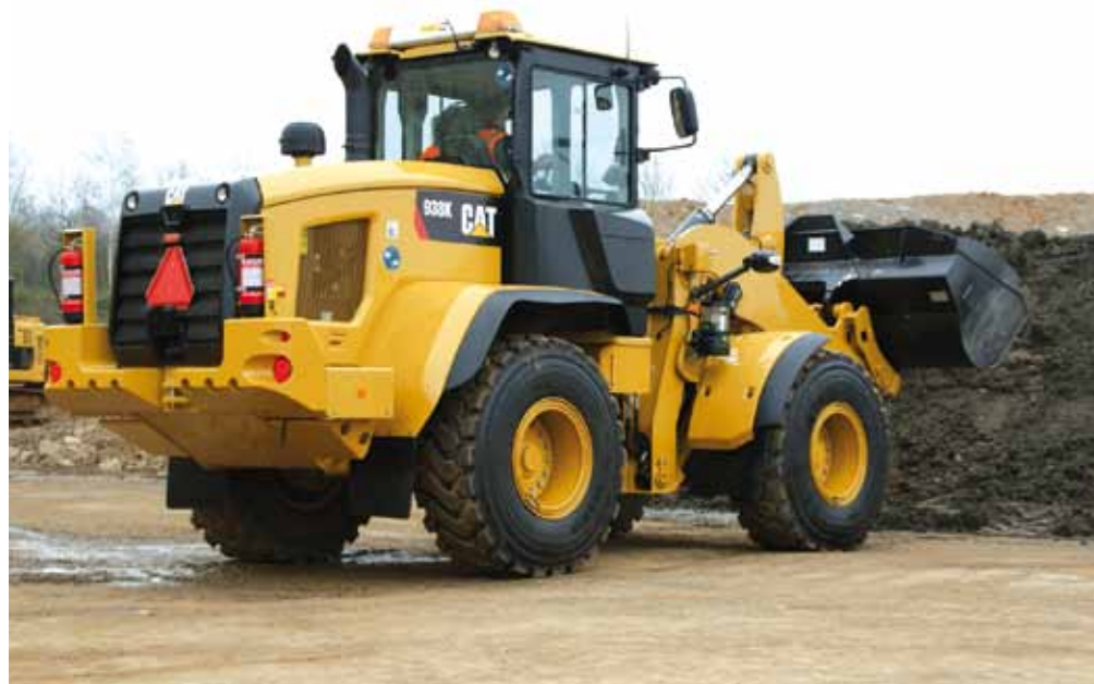
Met Z-kinematiek op de hef, hydrostatische aandrijving en een Stage IIIb-zescilindermotor: de 15,9-tons 938K.
