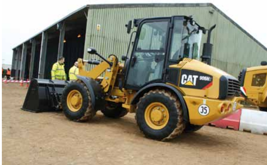
De 5,6-tons 906H2-kniklader heeft - net als de 907H2 en de 908H2 - een C3.3B-driecilindermotor van 55 kW (75 pk). Vooral in Duitsland worden deze laders traditioneel veel verkocht.
