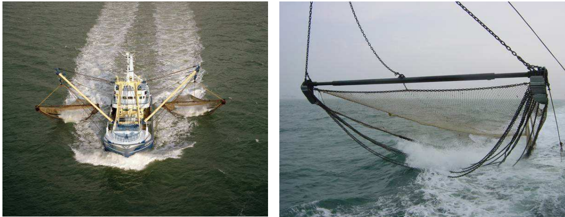
Figuur 4.1.1: Een boomkorschip (links) en een boomkornet (rechts).
