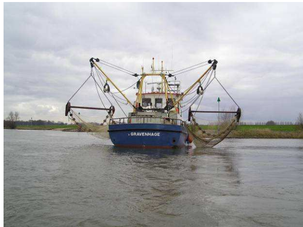
Figuur 7.1.1: Onderzoeksvaartuig Stern met een vistuig vergelijkbaar met een garnalenkor.
