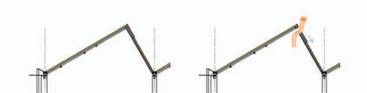
Figuur 3.4. Het schuifluchtraamsysteem in gesloten positie (links) en in gedeeltelijk geopende positie (rechts).
