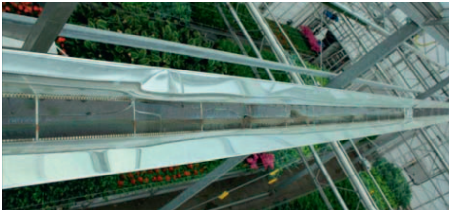
Figuur 4.5. Het eerste prototype PV-collector in de DaglichtKas is zwaar gehavend door de zomer gekomen. De gemeten stroomproductie is daarmee verre van representatief voor het potentieel van de DaglichtKas.
