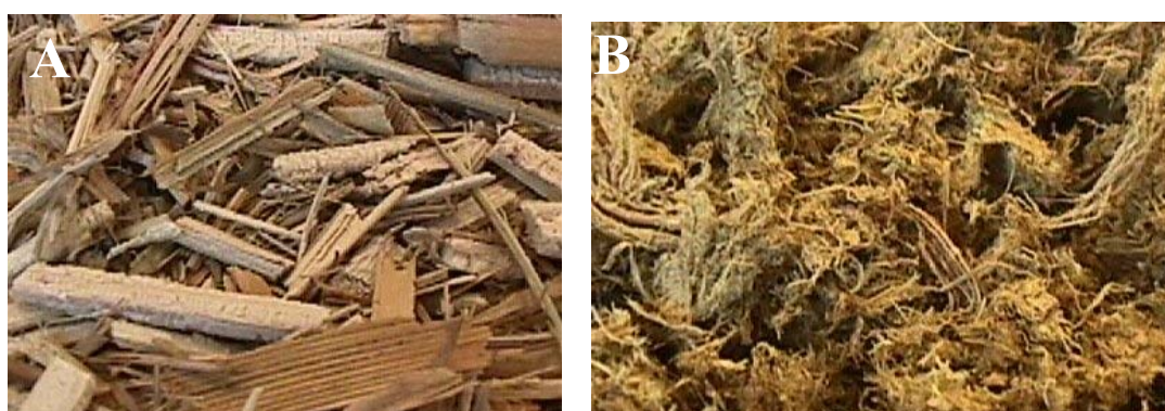
Fig. 11. A) Miscanthus en B) Gedelignificeerde Miscanthus . Geëxtrudeerde Miscanthus is gedelignificeerd door incubatie met NaOH (12% w/w droge stof) bij 70 °C gedurende 4 uur.
