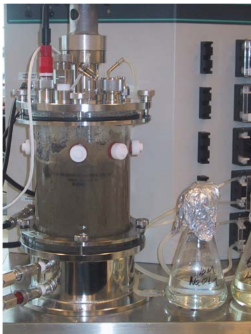
Fig. 14. Enzymatische hydrolyse van aardappelstoomschillen. Incubatie vindt plaats bij 70 °C met \alpha -amylase en bij 60 °C met amyloglucosidase gedurende enkele uren.
