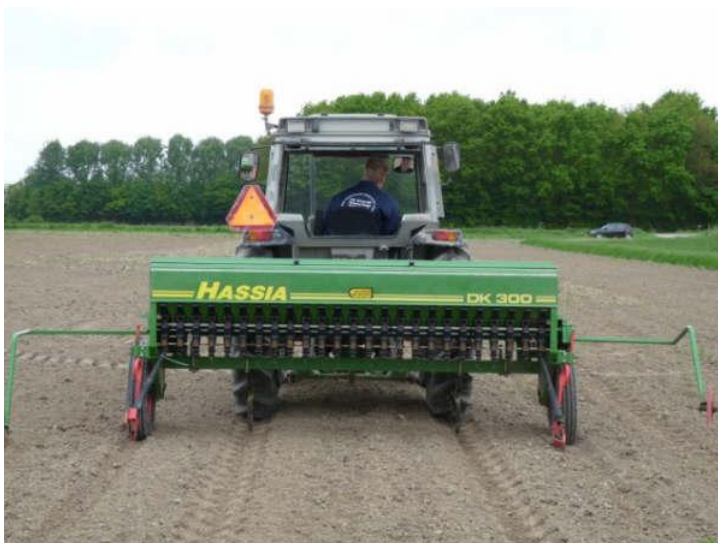
Verenmeel strooien met een nokkenradzaaimachine
