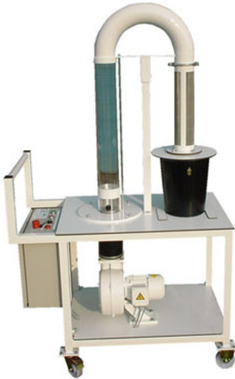
Fig. 3.1 Dit apparaat blaast lucht en sorteert dus op de combinatie van luchtweerstand en gewicht. Deze uitvoering is vooral geschikt voor kleine partijtjes van bijvoorbeeld proefstations. www.seedquest.com
