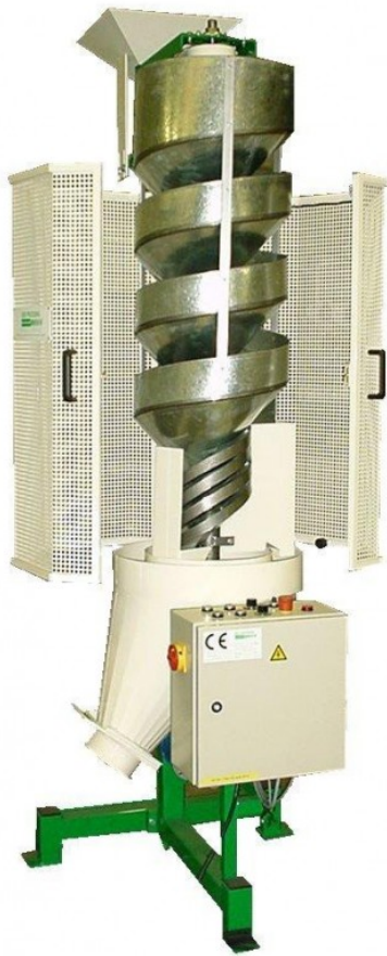
Fig 3.3 Slingertrieur. Rond zaad kan hiermee gescheiden worden van zaad met een andere vorm. Uit koolzaad kunnen zaden van onkruiden zoals zwaluwtong en zuring verwijderd worden. www.seedprocessing.nl
