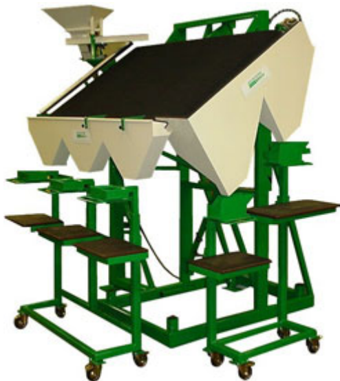
Fig. 3.2 Doekenmachine. In dit apparaat rollen ronde zaden naar beneden. Scheiding op vorm. Bron: http://www.seedprocessing.nl
