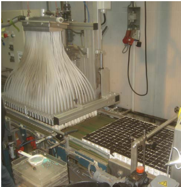
Fig 6.1 Op de kwaliteitsafdeling van een veredelingsbedrijf staat vaak apparatuur om vlot een flink aantal zaden te zaaien.
