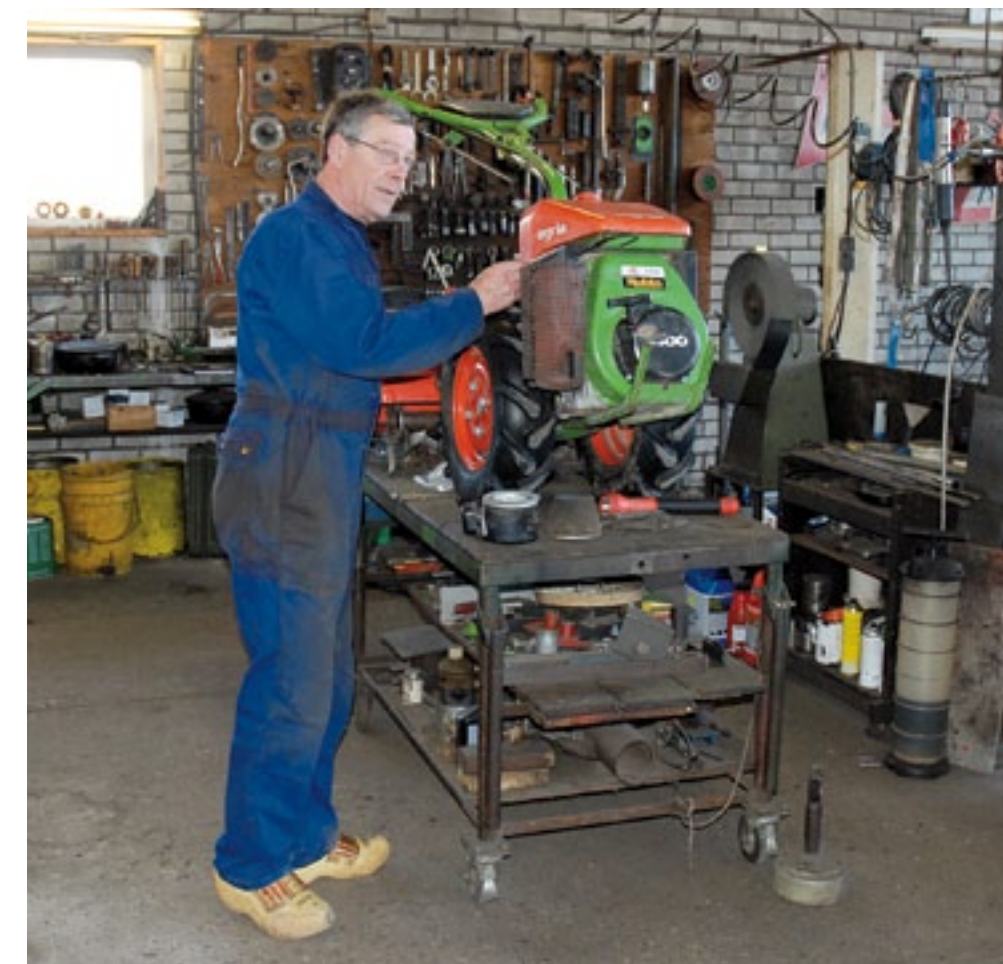
De tweewielfrees wordt aangedreven door een benzine- of dieselmotor. De motoren van deze machines zijn veelal eencilindermotoren.
