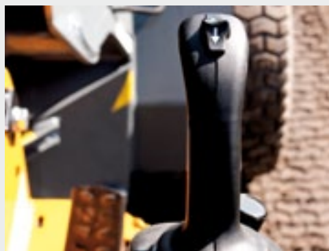
De elektrohydraulische omkeerinrichting vervangt het rijpedaal.
