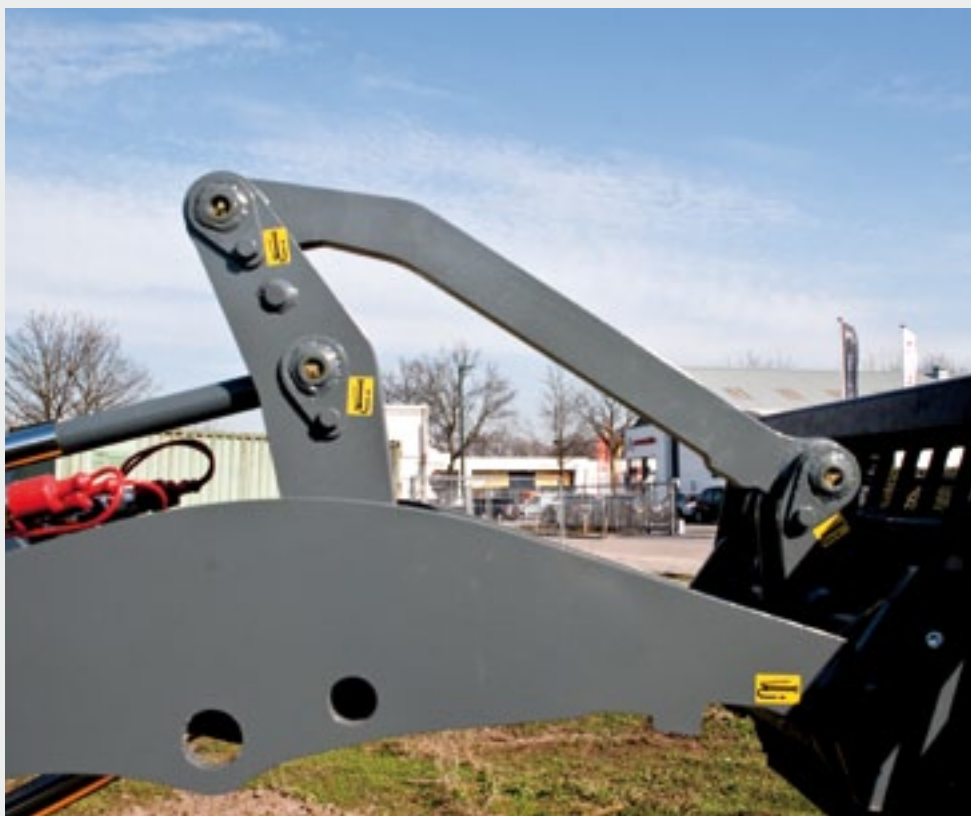
De 20-serie werd niet eerder uitgerust met parallelgeleiding. Op de 204 gebruikt Tobroco voor het eerst de P-kinematiek om het aanbouwdeel in positie te houden.
