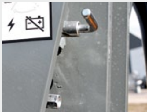
De met de accupolen verbonden pinnen dienen om een starthulp aan te sluiten.
