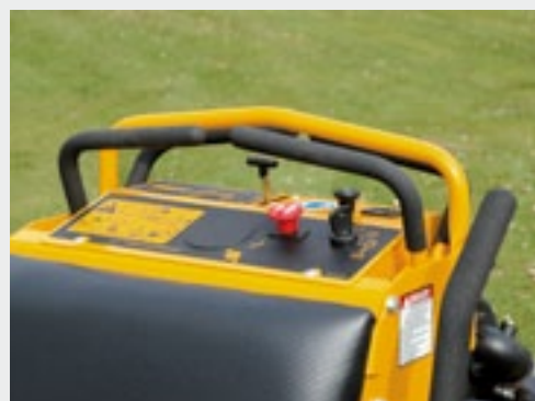
Met de vingers om de gele stang, de handpalmen op de zwarte en de duim erachter bepaal je de snelheid en de stuurbeweging.
