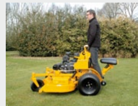
De Sentar is qua opbouw in grote lijnen vergelijkbaar met de Stander, maar biedt de keuze uit staan (boven) of zitten (rechts).
