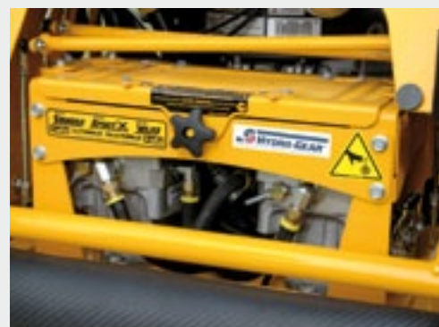
Elk van de beide achterwielen heeft z'n eigen hydromotor. Het ene wiel kan daardoor ook tegengesteld draaien aan het andere.
