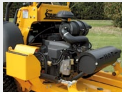
De motor van Kawasaki levert 13,4 kW bij een maaibreedte van 91 cm. Dat loopt dan op naar 23,1 kW bij 155 cm maaibreedte.
