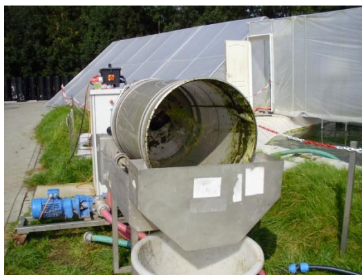
Figuur 17: trommelfilter waarmee het algenwater wordt gefiltreerd
