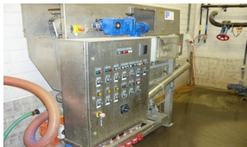
Figuur 12: flotatie unit zoals opgesteld in Olburgen. De algen gaan drijven onder toevoeging van lucht
