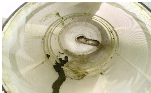
Figuur 13: de samengeklonte algen kunnen niet door het doek van de trommelfilter en worden geoogst
