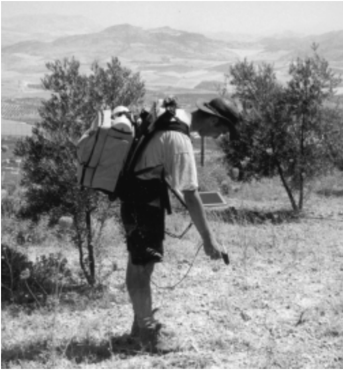
Figuur 2. Metingen in het veld. De spectrometer zit in de rugzak. Met de 'pistol-grip' wordt op het object gericht. De laptop zorgt voor de aansturing van het apparaat en de dataopslag.
