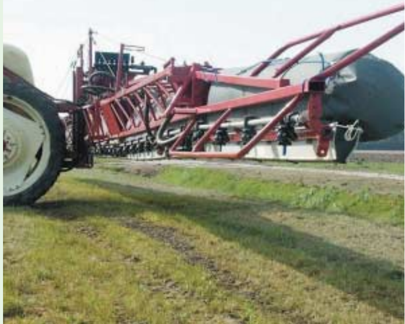
Bij lage doseringen herbiciden op klein onkruid neemt de effectiviteit af bij doppen met meer dan 50% driftreductie. Luchtondersteuning zoals op deze spuitmachine geeft afname van drift met behoud van effectiviteit.
