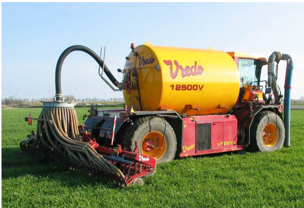
Figuur 3.6.1. De zelfrijdende bemester die is gebruikt voor het aanleggen van de proeven op proefbedrijf Oostwaardhoeve.
