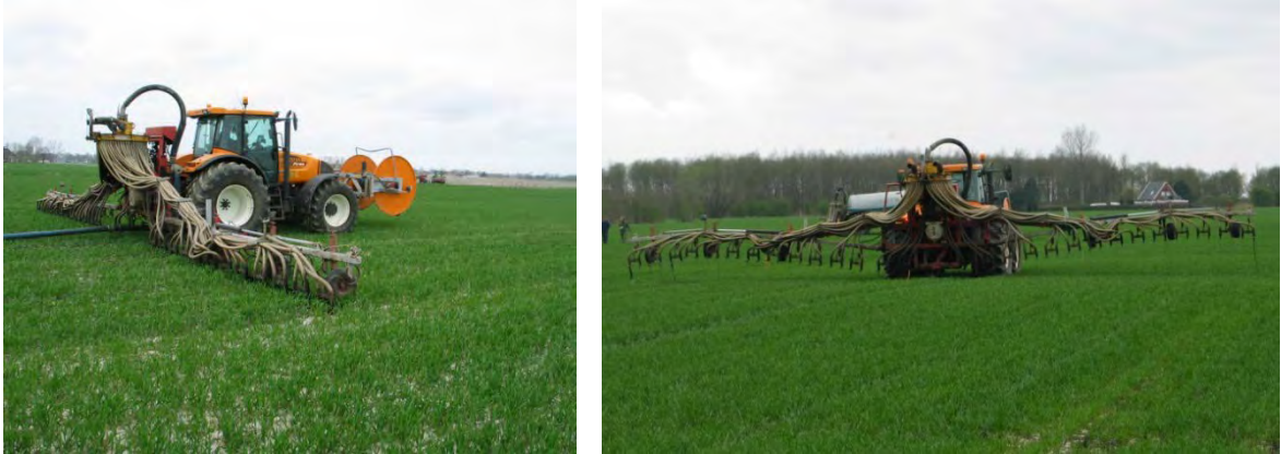
Figuur 3.3.2 Trekker + sleepslangaanvoer + sleufkouterbemester, werkend op de grond (links) en zonder drijfmest boven de grond (rechts).
