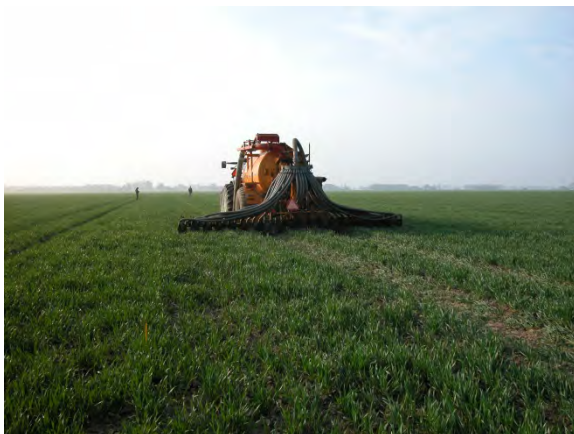
Figuur 3.1.1. Trekker + mesttank met zodenbemester (links) en detail van de zodenbemester (rechts).
