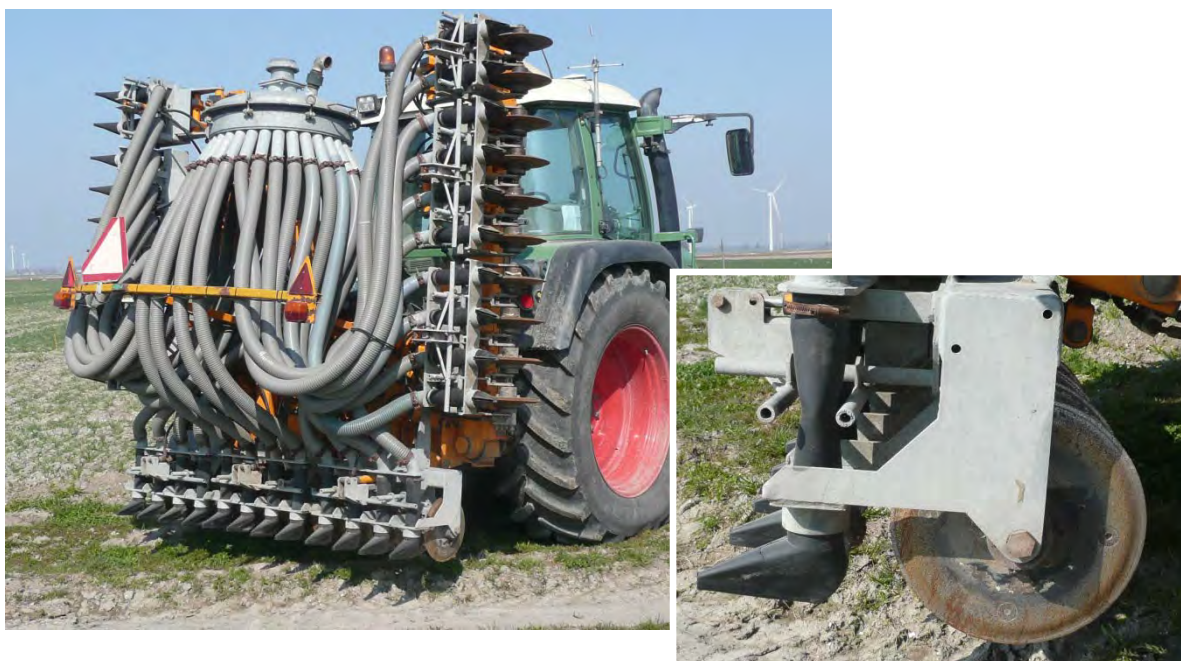
Figuur 3.7.1. De machine van PPO-ASG waarmee het snijeffect in diverse groeistadia in wintertarwe is onderzocht. Inzet is een detailopname van een bemesterelement.
