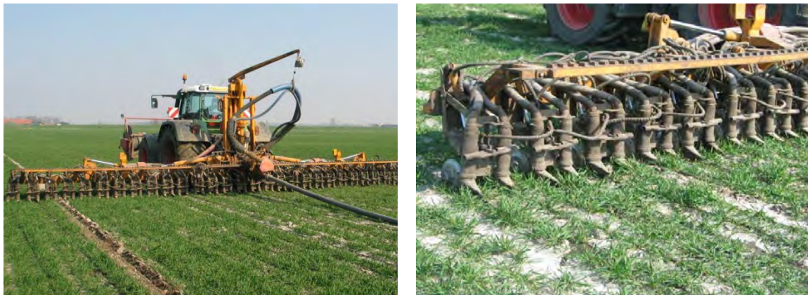
Figuur 3.2.1. Trekker met sleepslangaanvoer met zodenbemester (links) en detail van de zodenbemester (rechts).
