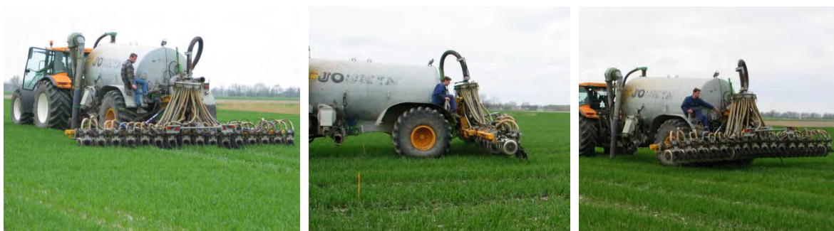
Figuur 3.3.1. Trekker + mesttank + zodenbemester met bemester in de grond werkend (links), boven de grond werkend (midden) en gegeven zonder het geven van drijfmest (rechts).
