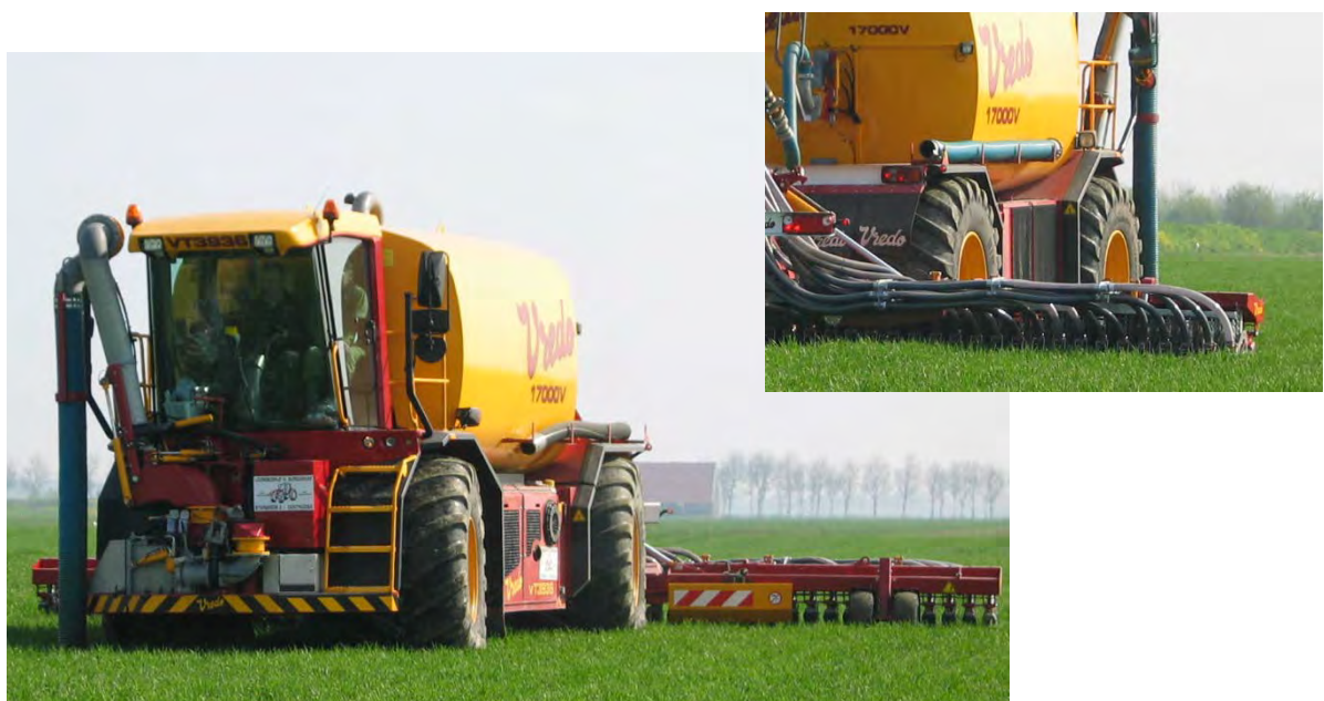
Figuur 3.8.1. De zelfrijdende zodenbemester (in hondegang situatie) die is gebruikt voor aanleg van de proef.
