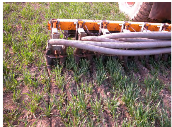
Figuur 3.1.1. Trekker + mesttank met zodenbemester (links) en detail van de zodenbemester (rechts).
