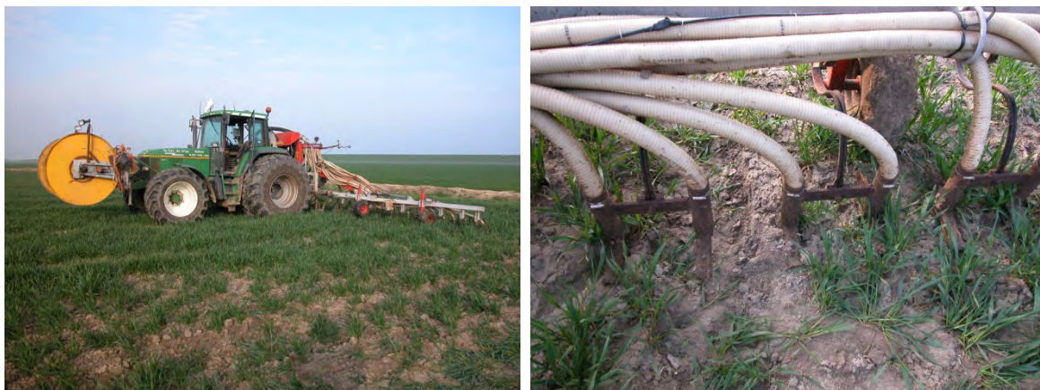
Figuur 3.1.2. Trekker + sleepslangaanvoer met sleufkouterbemester (links) en detail van de sleufkouterbemester (rechts).
