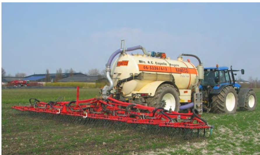
Figuur 3.4.1. Wiedegbemester van loonbedrijf Capelle uit Nagele.
