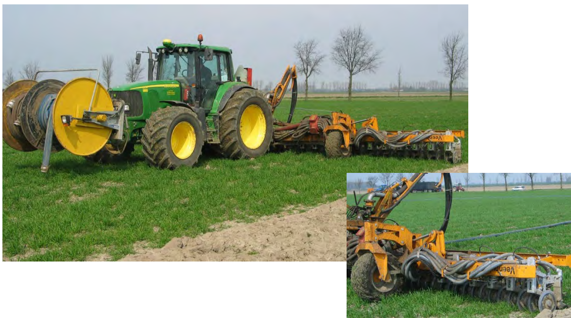
Figuur 3.5.1. De trekker + sleepslangaanvoer met zodenbemester die gebruikt is voor aanleg van de proef.
