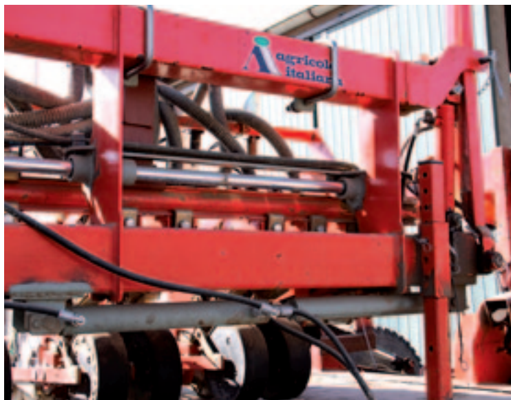
▲ Gebruiker Ad Testers maakte het frame uitschuifbaar door middel van twee cilinders. Ook de markeur schuift mee. Voor spuitsporen schuift hij 40 cm uit.
