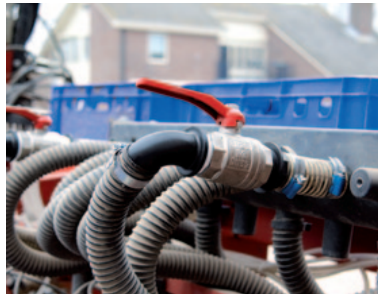
▲ Om in spuitsporen een rij af te sluiten, bouwde Van Beem zelf kranen op de luchttoevoer. Hiermee is tijdelijk de buitenste rij uit te zetten.
