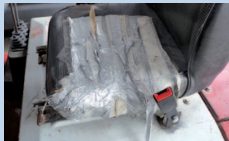
▲ De stoel mag niet beschadigd zijn. Een natte zitting werkt niet prettig, waardoor de bestuurder mogelijk niet scherp is, zo is de gedachte. De bestuurdersbeveiliging moet werken, zodat de heftruck niet uit zichzelf kan gaan rijden. Controleer dat.
