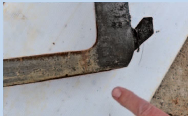
▲ De lepels van heftrucks mogen niet meer versleten zijn dan de dikte in het verticale deel min 10 procent. Bij een dikte van 45 mm betekent dat minimaal 40,05 mm. De lepels op de foto zijn dit stadium al voorbij en de kans op spontane breuk is levensgroot aanwezig. De gevolgen kunnen desastreus zijn.
