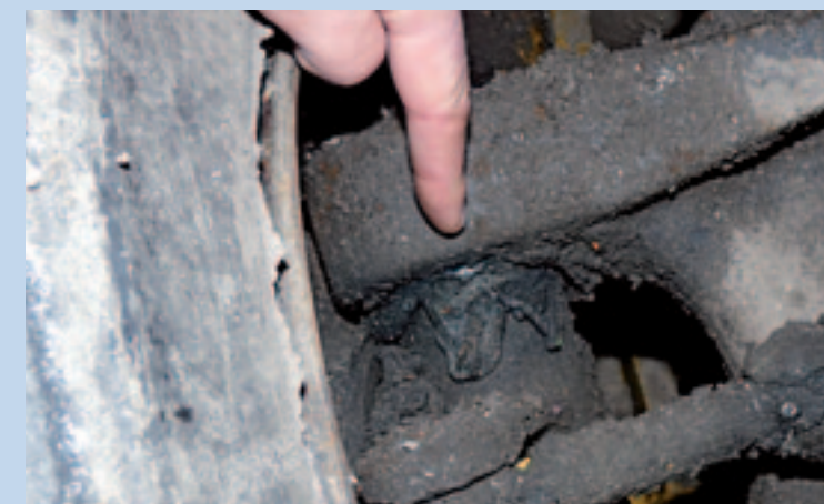
▲ Heftrucks zijn voorzien van een contragewicht dat op de stuuras rust. Om de fusees goed te kunnen doorsmeren, moet de heftruck op een krik staan. Zorg voor juiste afsteuning, zodat je veilig kunt werken. Het instructieboek helpt bij het vinden van de frequentie en of de schommelras dit ook nodig heeft.
