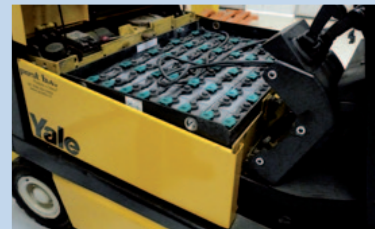
▲ Elektrische heftrucks vragen weinig onderhoud, zijn goedkoop in gebruik, stil en milieuvriendelijk. Onderhoud aan de batterij beperkt zich tot het opladen en het bijvullen van het waterniveau. Draag dan handschoenen en beschermende kleding en rook niet. Bij het opladen kan knalgas ontstaan.
