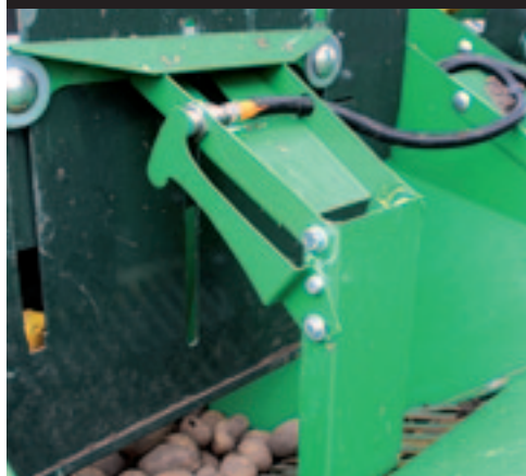
▲ Een metalen strip dekt een sensor af. De poters worden nu toegevoerd via een hydraulisch aangedreven band.
