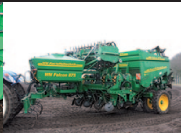
▲ In transportstand is de aardappelpootmachine 3,30 meter breed. De vier buitenste pootelementen zwenken onder de kunstmestbak.
