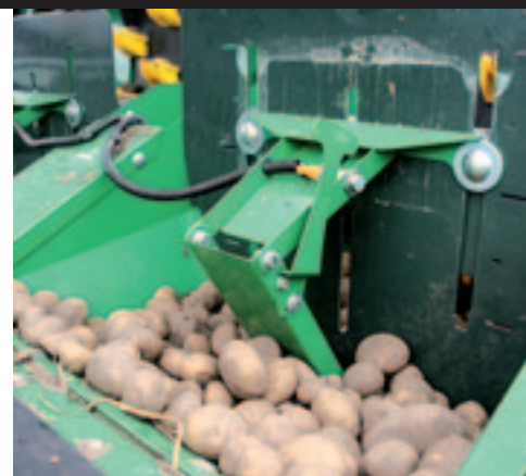
▲ Hier dekt de metalen strip de sensor niet af. De bak zit vol, de band staat stil en er worden dus geen aardappelen meer toegevoerd.
