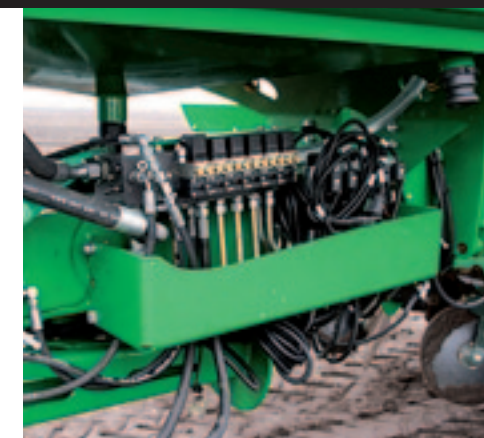
▲ Het hydraulische ventielenblok onder de tank voor de vloeibare kunstmest. De ventielen worden via Canbus aangestuurd.
