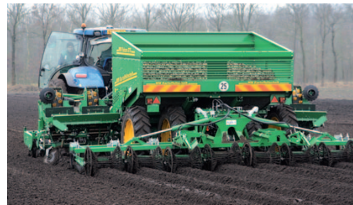
▲ De achtrijige aardappelpootmachine is voorzien van aanaarders en diabolorollen met spijlen. Poten en rug vormen gaat nu dus in één werkgang. Op zware grond ontbreken de aanaarders en spijlenrollen.
