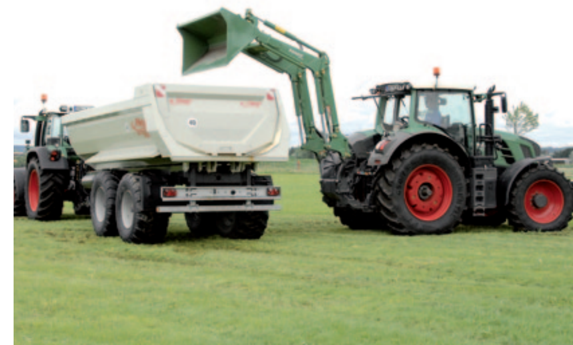
▲ De achterlader van Fendt bestaat uit de arm van de Fendt voorlader die via de driehoekige koppeldelen en een adapter in de hef wordt bevestigd. De oversteek is vergeleken met een voorlader, groot. De combinatie als geheel is wel vrij lang en vraagt dus meer manoeuvreerruimte dan als traditionele voorlader.
