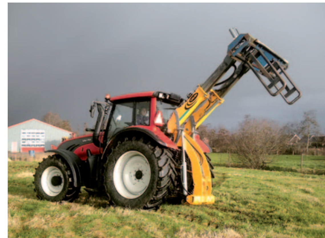
▲ De achterlader van Tjalma zit dicht op de trekker waardoor ook de voorwielen goed grip houden. De dubbele arm kan 0,8 meter telescoperen voor extra bereik in de lengte (lees: laad- en loshoogte). Ten opzichte van een voorlader rij je met een achterlader op onverharde grond verhoudingsgewijs weinig kapot.
