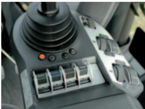
▲ Op de voorgrond de vier flippers van de hydrauliek; rechts de beide hefbedieningen.
