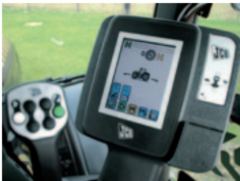
▲ De functies onder de knopjes op de rijhendel zijn via het touchscreen zelf te bepalen.
