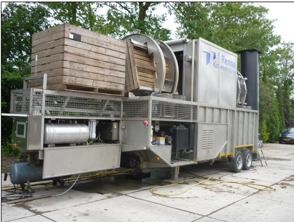
Foto 4 Ondersteboven kantelen van kist voor reiniging
