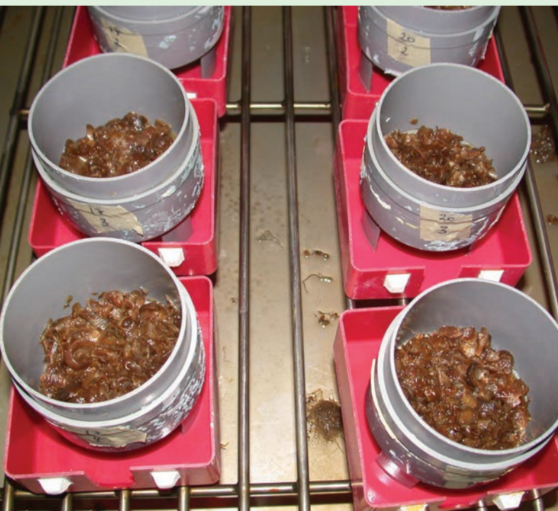
Extractie van aaltjes uit aardappelschillen: de spray-mist methode.
