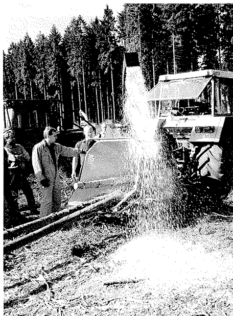
Mobiele installaties verchippen hout in het bos
