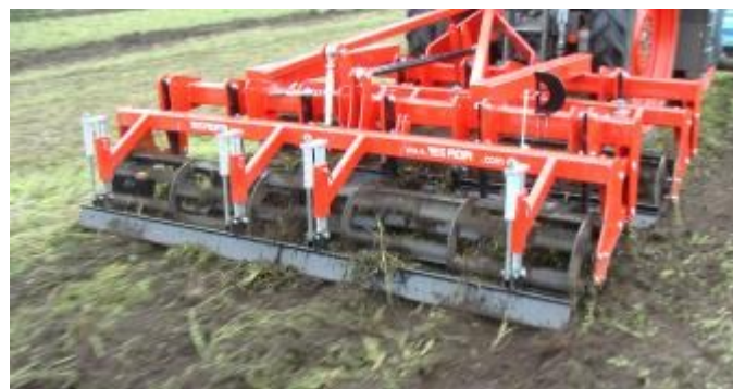
Figuur 1. VSS grondbewerkingsmachine voor NKG
