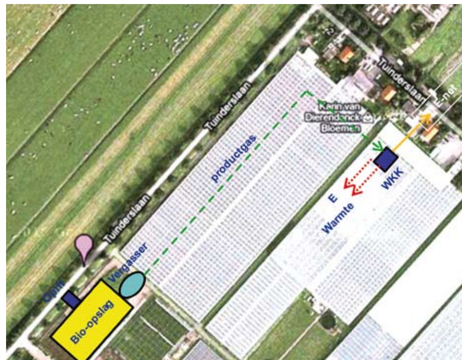
Foto 9: Luchtfoto inpassing vergasser-WKK en opslag bij kwekerij Zwarts.
