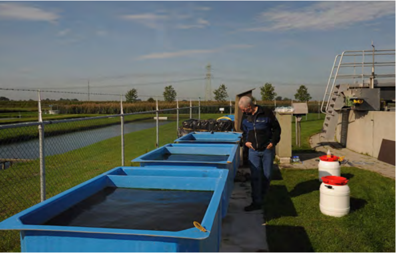
AFBEELDING 3.2 OPSTELLING MESOCOSM BIJ AQUALÂN, RWZI GROU
