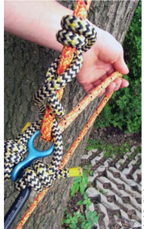
Lijn doorhalen door middel van de Ropeslider
