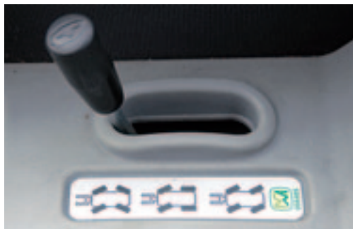
De chauffeur kan kiezen uit voorwiel-, vierwiel- of hondengangbesturing.
