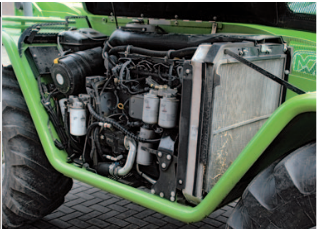
De viercilinder Deutz TCD levert in de P40.7 CS een maximumvermogen van 102 kW (140 pk). Van de oliepomp bedraagt de maximumopbrengst 130 l/min.
