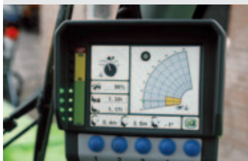
Het nieuwe display geeft helder de stabiliteit van de machine weer.
