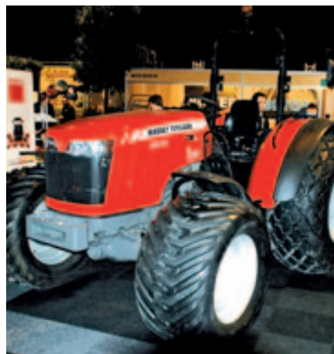
Breed 'schoeisel' geeft een trekker 'uitstraling' en zorgt (daar is het meestal om begonnen) voor een lage bodemdruk. Deze 3635 van Massey Ferguson van Rovadi in de stand van dealer Swinkels uit Soerendonk staat met de voorwielen op de Twin 404 van Trelleborg in de maat 550/45-22.5. Het rubber op de achteras is van dezelfde Zweedse bandenfabrikant, maar dan van het type Tractor 409 met de maatvoering 23.1-26.
