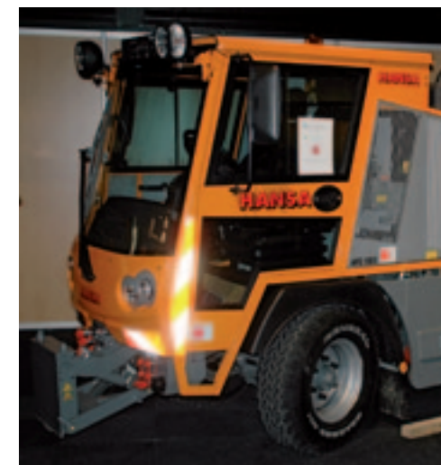
In de aanlooproute naar de hal, dus op een soort A1-locatie, stond de APZ 1003 van Hansa uit het Duitse Selsingen. Deze werktuigendrager is van een breed scala 'gereedschappen' voor op- en aanbouw te voorzien. Dat gamma loopt van sneeuwschuiven en -frezers via bezems, kieperbakken en hydraulische armen naar zuiginstallaties. De keuze in banden loopt van een 265/75R16 via een 285/65R18 naar een 315/55R16.
