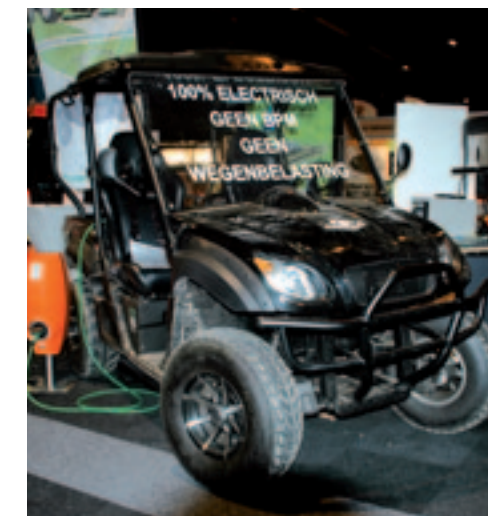
Honderd procent elektrisch, geen wegenbelasting en geen bpm. Dat staat te lezen op de voorruit van deze fluisterstille transporter van Frisian Motors. Als krachtbron dienen negen loodaccu's van elk 8 volt die een plaats vinden onder de beide stoelen. Dit pakket is volgens de fabrikant uit het Friese Bakkeveen voldoende voor een top van 60 km/h en een actieradius tot 80 km. Zie het 'profiel' in het hart van dit nummer.
