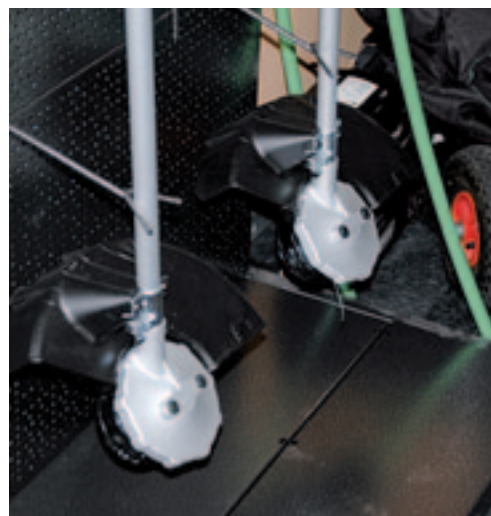
De elektrische bosmaaier (motorzeis mag ook) van Hitachi is sinds Papendal op de markt en onderscheidt zich van soortgenoten doordat de elektromotor geïntegreerd zit in de maaikop. Er loopt dus geen aandrijf-as door de framebuis. Volgens Jan Willem van Tuijl van Hitachi Power Tools zorgt deze constructie voor een perfecte balans van de machine en nauwelijks slijtage. Ze zijn er met accu's van 14,4 volt en van 18 volt.
