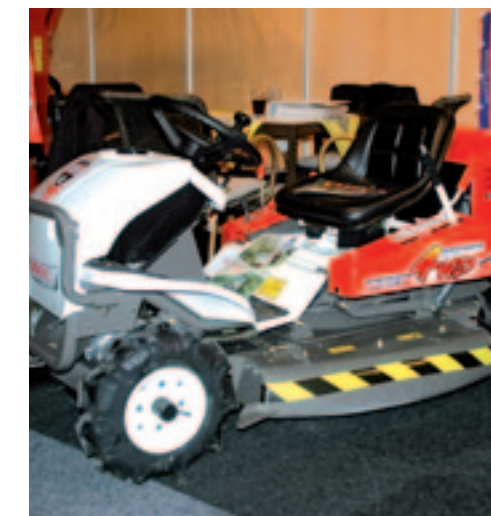
De Orec Rabbit spreekt met zijn skelterachtige voorkomen vooral tot de verbeelding bij jongeren die het werk met een gewone zitmaaier al gauw 'tuttig' vinden. Deze compacte Japanner met vierwielaandrijving en een extreem laag zwaartepunt is er met een werkbreedte van 820, 880 en 975 mm. Een motor van Kawasaki is de standaard, maar ze zijn ook leverbaar met een krachtbron van Honda en Vanguard.
