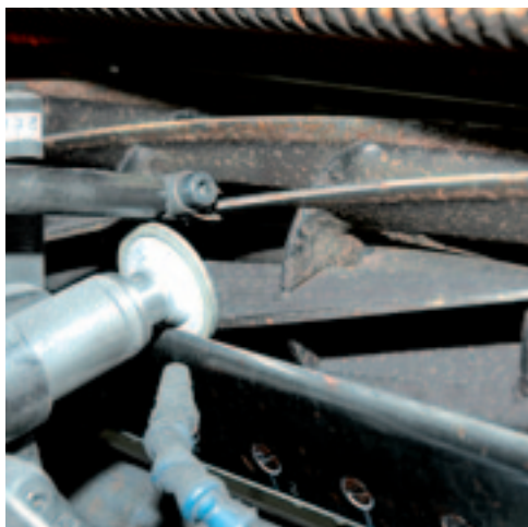
Met een smalle steen slijpt deze SBR900 het ondermes van een maaier. Is er minder ruimte, dan loopt een vinger mee om de kooi te draaien.
