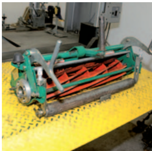
Deze Neary slijpmachine heeft aan de voorzijde een lift om de maaier op de bank te tillen. Alternatief is een hijsarm met een lier.
