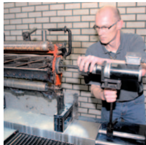
Johan Bruntink koos voor een gecombineerde machine die alle messen kan slijpen zonder dat deze gedemonteerd hoeven te worden.
