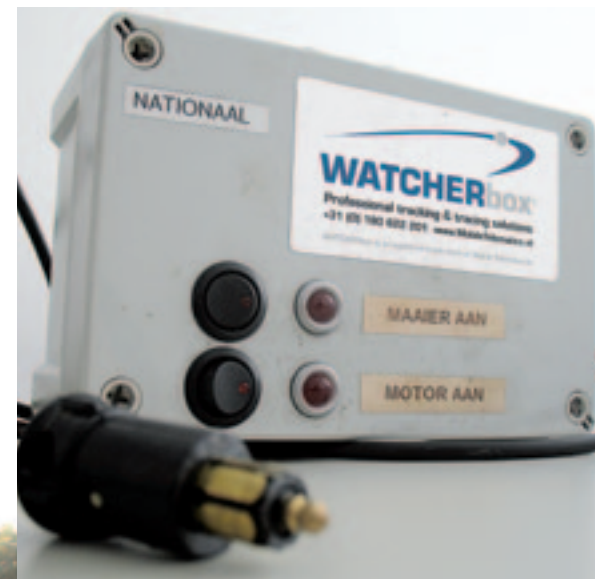
De volgapparatuur kan onzichtbaar ingebouwd worden of je kiest voor deze losse kast.
