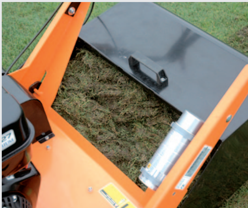
De Eliet E600 Compactor spaart een werkgang en opruimen is een kwestie van de opvangbak leegmaken. Rechts op de foto de spuitbus voor het smeren van de ketting die de rollen aandrijft.
