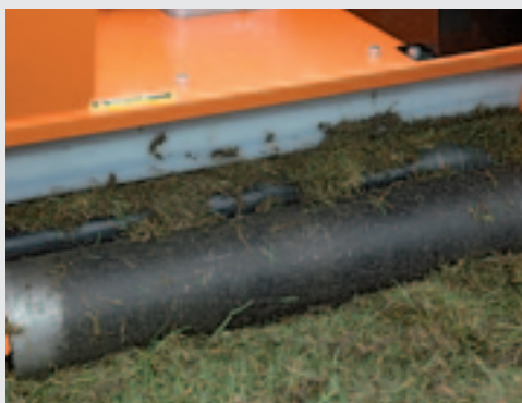
Het materiaal wordt tussen twee rollen door geperst, zodat er meer in de bak past.
