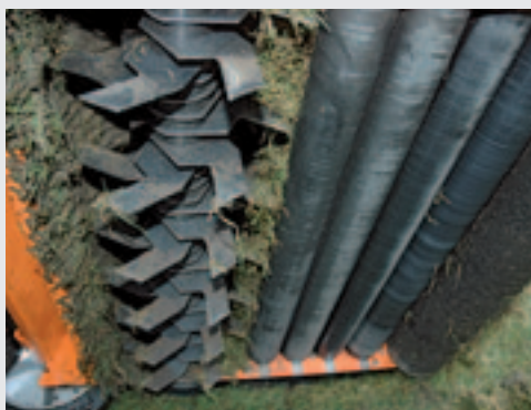
De overtop draaiende verticuteerrotor brengt het materiaal op een rollenbed.
