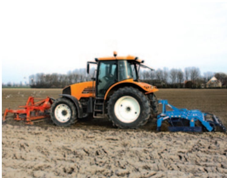
▲ Alle gebruikers geven aan dat een extra machine voorop de trekker nodig is om op kleigrond in één werkgang een goed zaaibed klaar te kunnen leggen.
