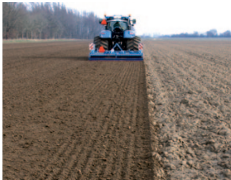
▲ Voor diepe bewerkingen op kleigrond, zoals het land klaarleggen voor plantuien, leent de machine zich niet goed. Op zware grond lopen de rollen vol.
