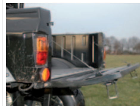
▲ De laadbak is 110 cm breed en 90 cm lang. Een lengte van 130 cm is een optie.
