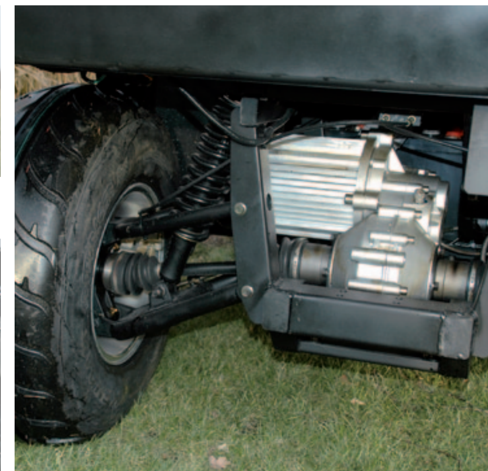
▲ De elektromotor zit op het differentieel van de achteras. Met deze combinatie komt de FM-50 probleemloos de bocht om. Een sper is volgens Frisian Motors voor normale omstandigheden niet nodig.
