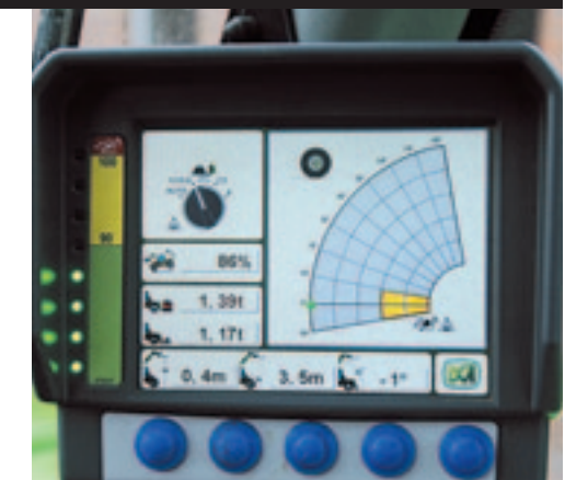
Het nieuwe display geeft op een informatieve manier de stabiliteit van de machine weer. Ook de bekende lampjes (links) zijn gebleven.
