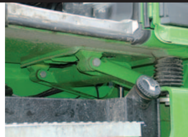
De vering bestaat uit een schaarmechanisme met daarin een hydraulische cilinder. De manchetten beschermen de verticale geleiding.
