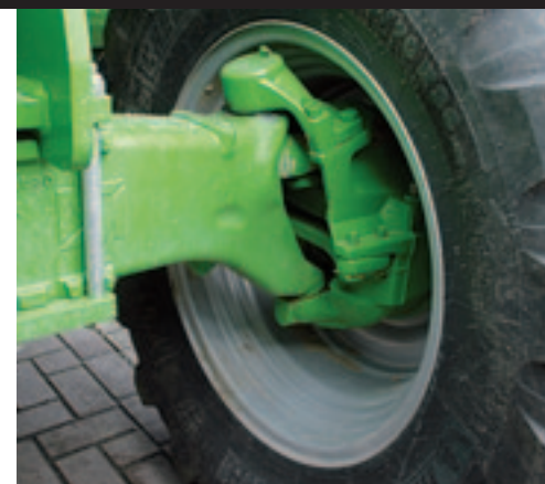
▲ Dankzij de portaalendvertraging in de naaf combineert de Turbofarmer volgens Merlo stabiliteit met een ruime bodemvrijheid.
