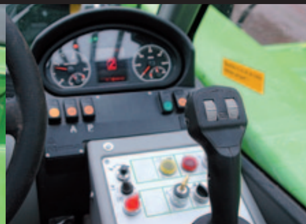
De hendel naar je toe is heffen, van je af dalen, naar links de bak achterover en naar rechts voorover. Telescoperen gaat via de rolknop.
