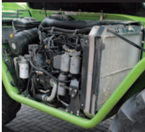
▲ De viercilinder Deutz TCD levert in de P40.7 CS een maximum van 102 kW/140 pk. Van de olie-pomp bedraagt dat maximum 130 l/min.
