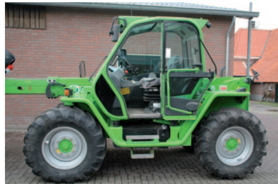
▲ Sterke punt van de Merlo cabine (los van de nu verkrijgbare vering) zijn het goede rondomzicht en het portier dat geheel open kan, zonder dat de breedte van de machine daardoor noemenswaardig toeneemt. Dat is een voordeel bij het manoeuvreren en ook als je veelvuldig in en uit moet stappen.
