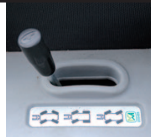
De chauffeur kan kiezen uit voorwielbesturing, vierwielbesturing of de hondengang. De laatste is handig om bij een muur weg te komen.
