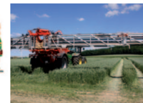
▶ Het strooien van geren is bij een pneumaat relatief eenvoudig. De sectiebediening laat zich vergelijken met die van een veldspuit.
