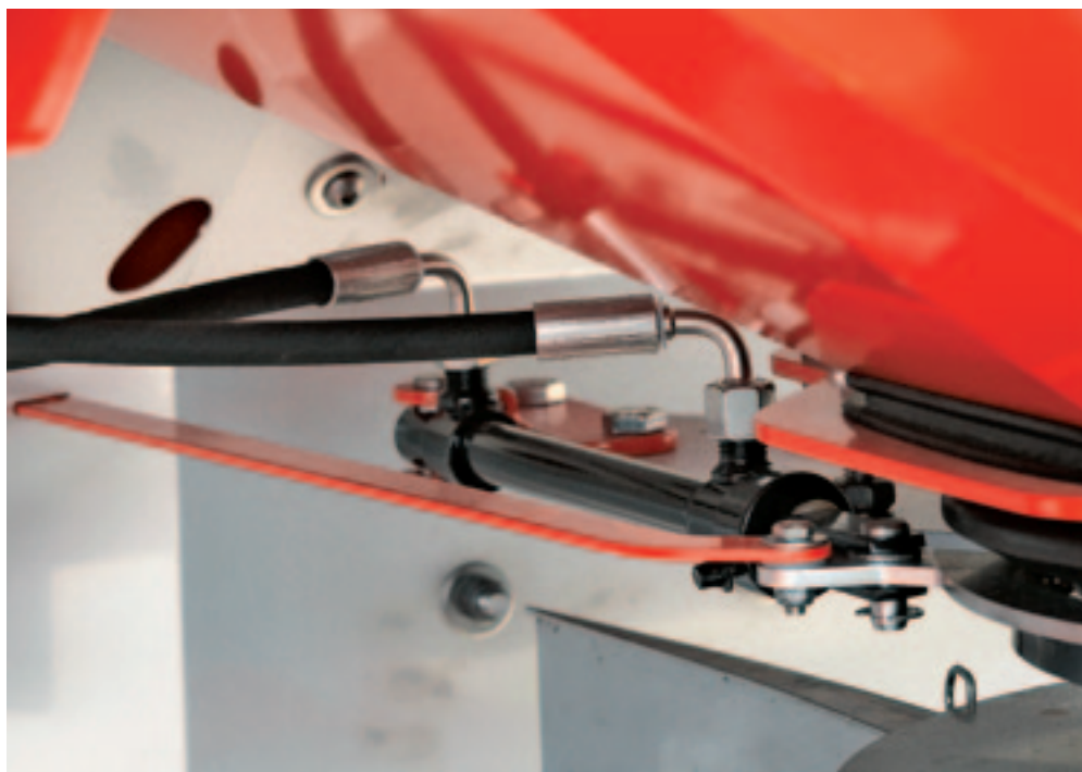
▲ Bij de DPX van Sulky regel je de strooibreedte door de positie van de uitstroomopening te veranderen.
