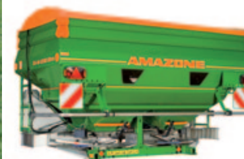
▶ Deze Amazone is voorzien van limiter. Een goede oplossing voor kantstrooien.
