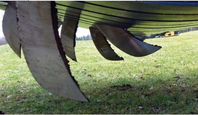
Imants-schudbeluchter doorsnijdt de toplaag van het grasland
