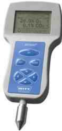
Afbeelding 8 Oxybaby ® om CO 2 - en O 2 -concentraties te meten en vast te leggen
