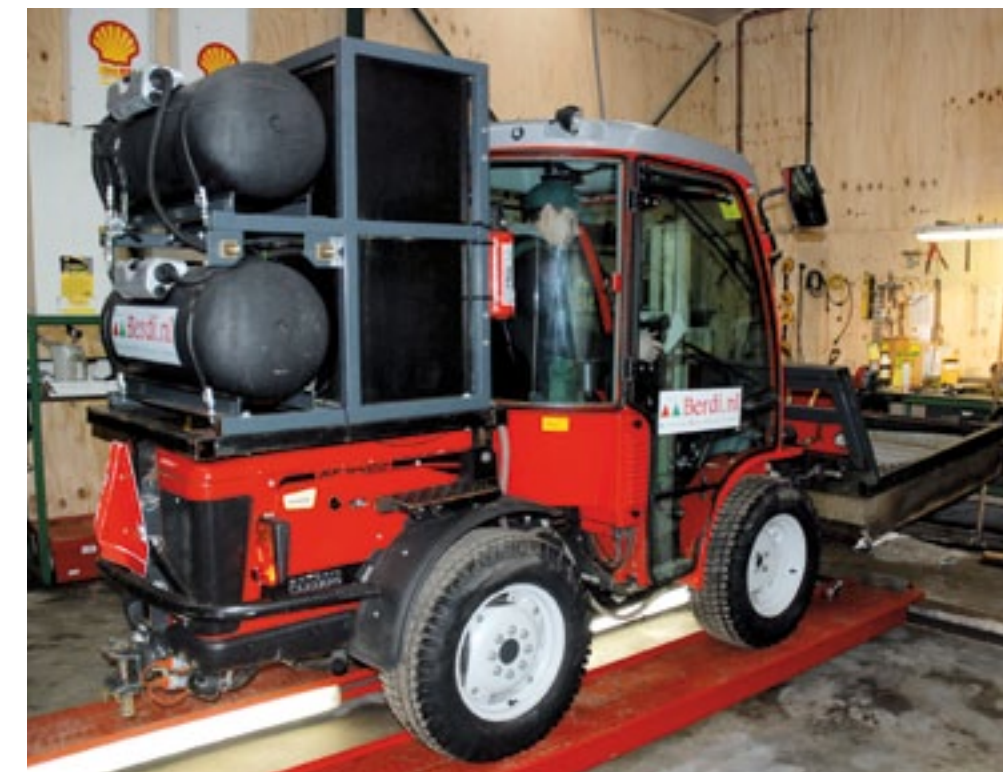
De onkruidbrander wordt een steeds belangrijker machine bij de bestrijding van onkruid op verhardingen. Alleen een goed onderhouden machine geeft het gewenste effect.
