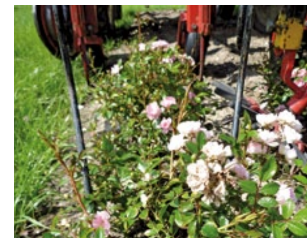
Een torsiewieder bestaat uit twee flexibele veertanden. Bij vaste planten blijkt hij iets minder effectief dan de vingerwieder.
